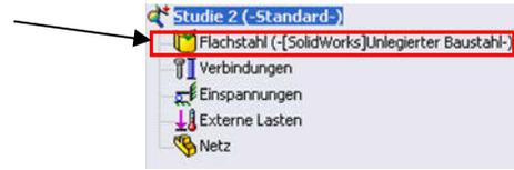
4. Definieren Sie eine feste Einspannung (**Fixierte Geometrie**) mit Rechtsklick auf **Einspannungen**.
