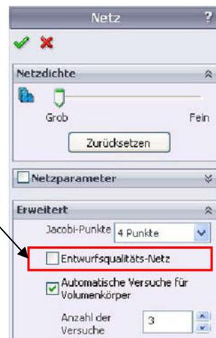
Tetraedische Volumenelemente 1. Ordnung (Entwurfsqualität) verfügen in jeder Ecke genau über einen Knoten. Das kann bei einer Analyse sehr schnell zu großen Fehlern führen.
